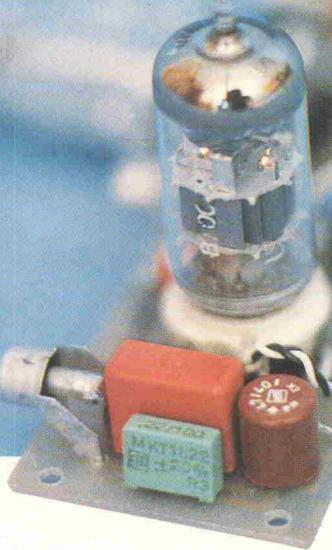
In den siebziger Jahren wurde eine sogenannte Spanngitter-Röhre mit der Typenbezeichnung PCC 88 als Eingangsrohre für Fernsehtuner entwickelt und eingesetzt. Hierbei wurde besonderer Wert auf geringes Rauschen und Stabilität gelegt. Gerade diese Kriterien sind aber auch bei einem Moving-Coil-Vorverstärker wichtig.
